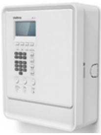
Central de alarme do tipo endereçável para até 256 dispositivos em seu laço, bivolt (110/220V), possibilidade de instalação em classe A ou B, com bateria interna de 24V e instalação de até 4 repetidoras, marca Intelbras ou similar.
